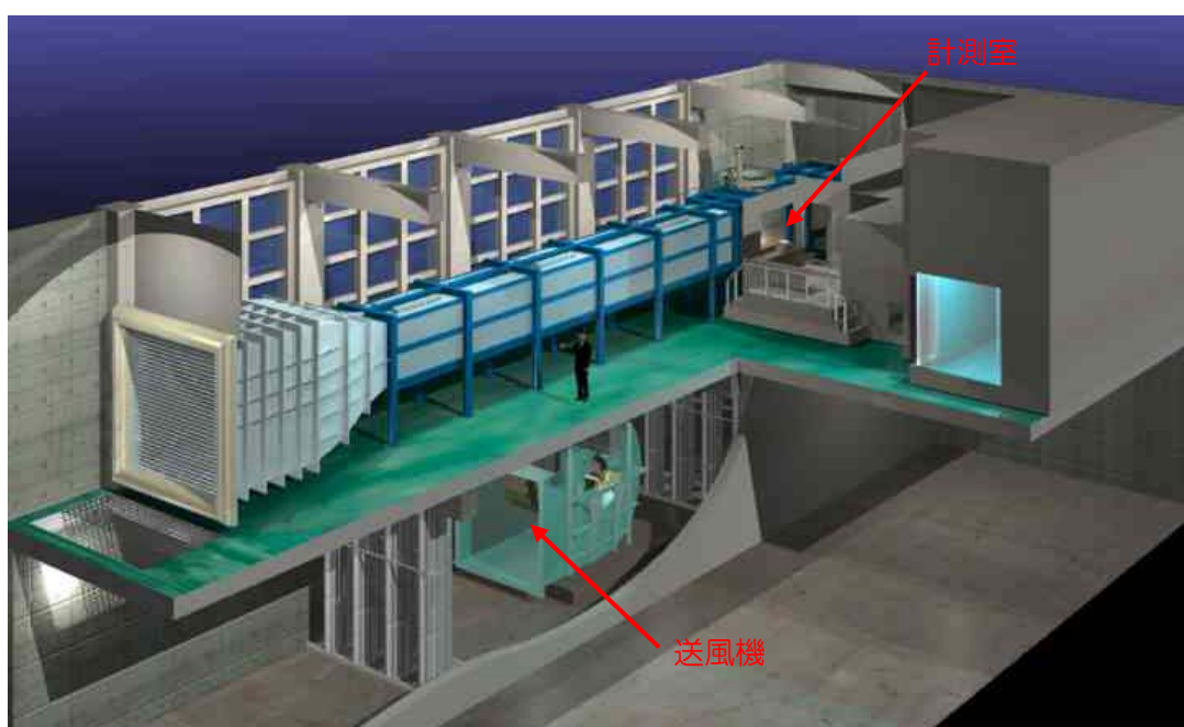
風洞実験装置全体図（上下に回流する形式です）
